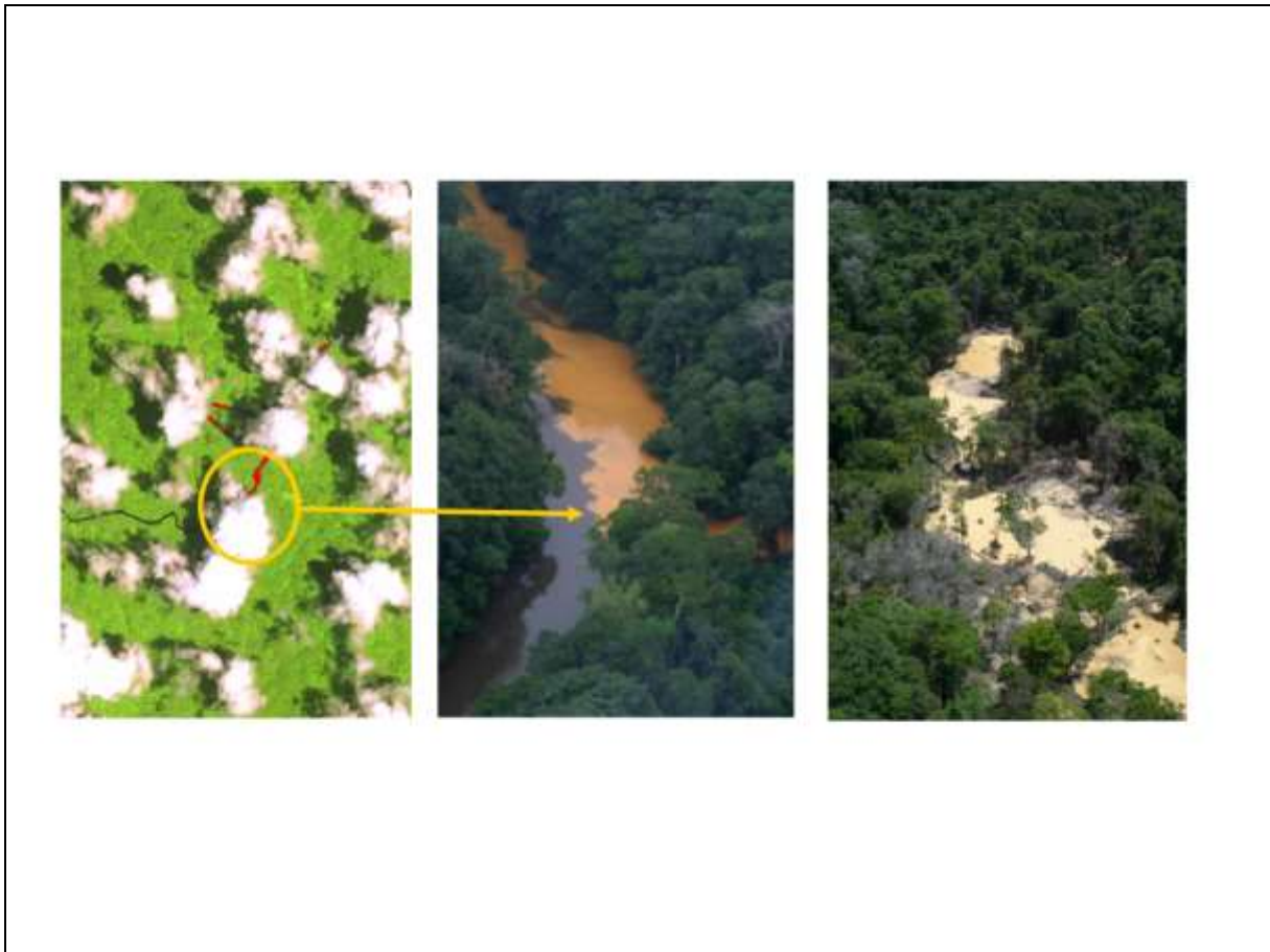
Figure 4 : à gauche sur une image SPOT a été détecté par le système une turbidité importante dans une rivière. Le système colorise en rouge les pixels identifiés comme turbides. La validation montre sur l'image centrale que cette turbidité est due à la confluence d'une rivière très polluée par l'orpaillage qui débouche dans la rivière principale qui n'est pas orpaillée. Le panache orange dans la rivière a bien été détecté par le système de surveillance. A droite une photo aérienne montre l'état d'un site d'orpaillage clandestin où les baranques actives sont très facilement détectables.
